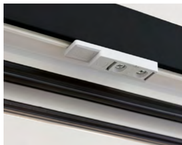
REED SWITCH magnetyczny czujnik otwarcia okna i drzwi, jest częścią systemu kontroli dostępu Smart Home lub systemu alarmowego
